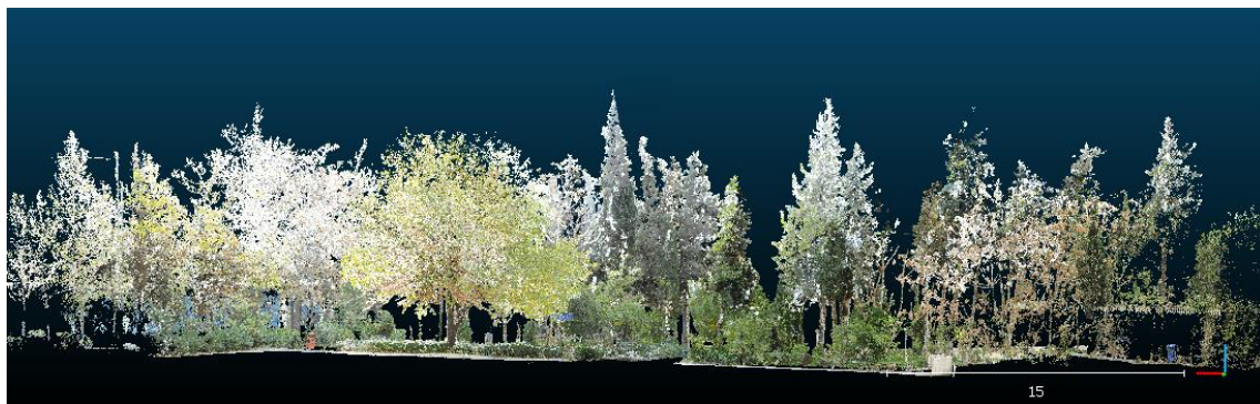
شکل ۱- نمایی از اسکن درختان توسط اسکن لیزر زمینی
