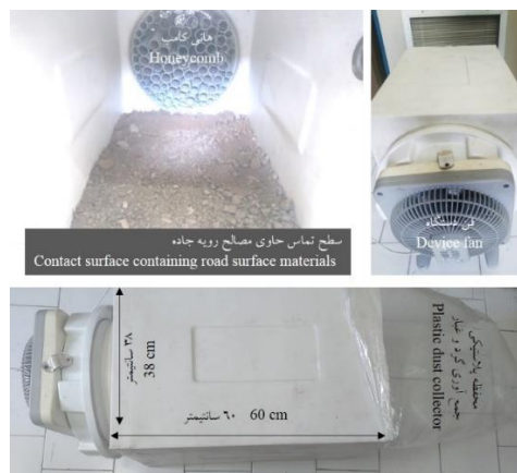
شکل ۳- ساختمان تونل باد مورد استفاده در پژوهش حاضر
