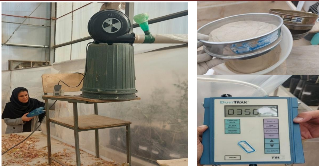
شکل ۱- فرآیند آماده سازی گردوغبار، الک کردن خاک، اعمال گرد و غبار بر روی نهال‌های داخل اتاقک و اندازه‌گیری مقدار غلظت آن با دستگاه گرد و غبارسنج
