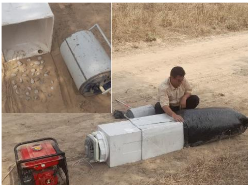
شکل ۲- شبیه سازی جریان باد و نمونه برداری گرد و غبار در عرصه
