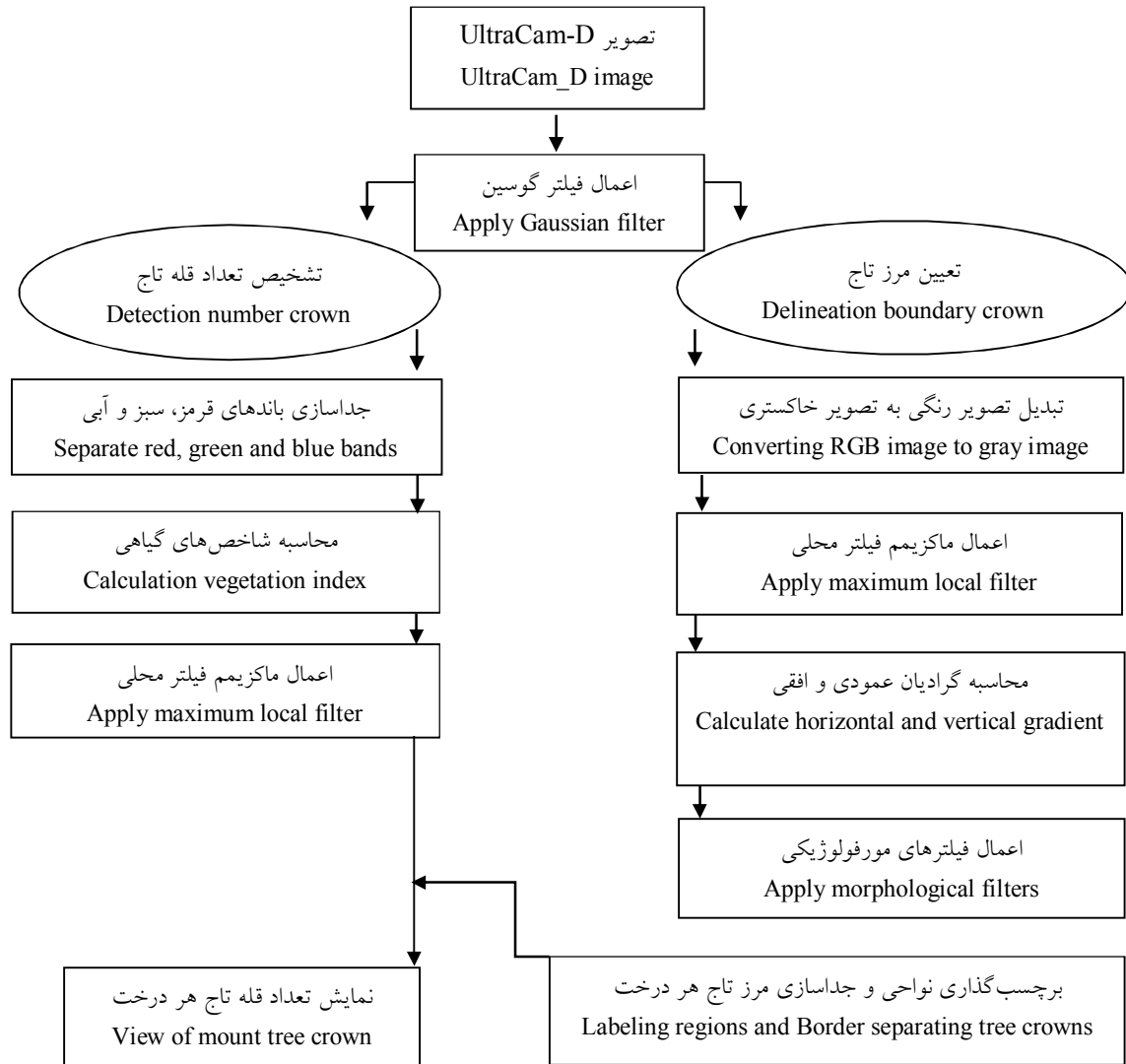
شکل ۲- مراحل تعیین و تشخیص تاج درخت به وسیله الگوریتم حداکثر فیلتر محلی
