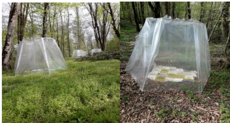
شکل ۱- چمبرهای اصلاح‌شده برای افزایش دمای هوا و کاهش مقدار تاج‌بارش
